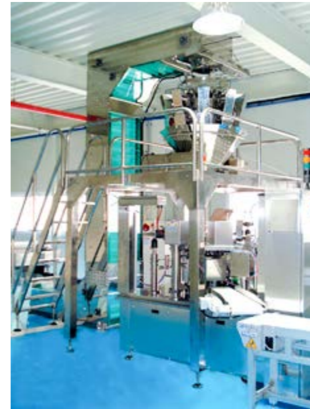
고형물 및 건과류 조합식 계량기 (냉동식품, 캔디, 애완동물 사료, 그레놀 식품 등)
