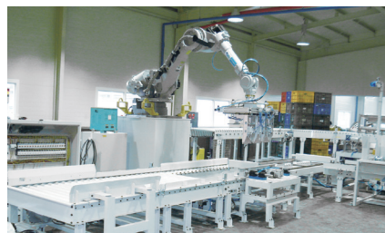
로봇 파레타이징 시스템 Robot Palletizing System
