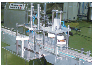
액물 충전기 Liquid Filler
